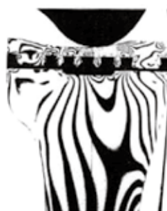
Obr. 4. Fotografie a celkový obraz izochromát při zatížení ve flexi 90°.
